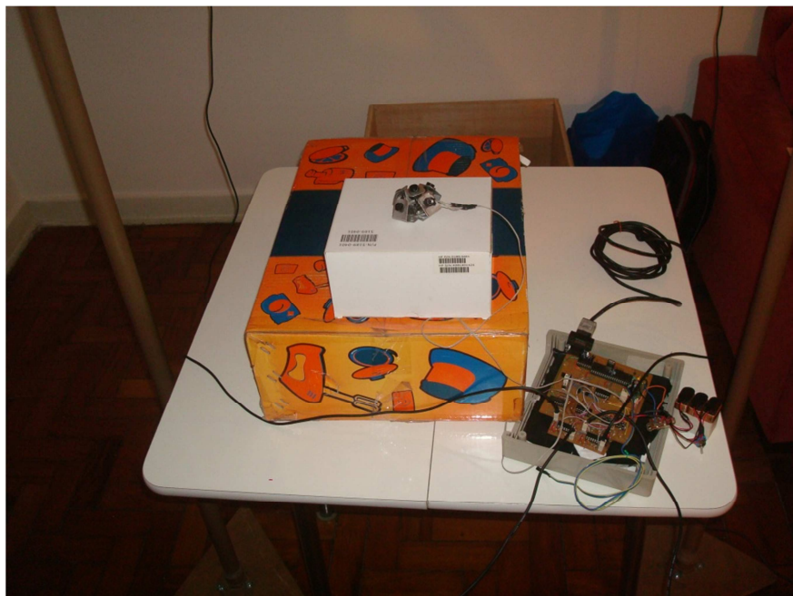
Figura D-10: Terceira alternativa proposta – emissor e circuito de controle.
