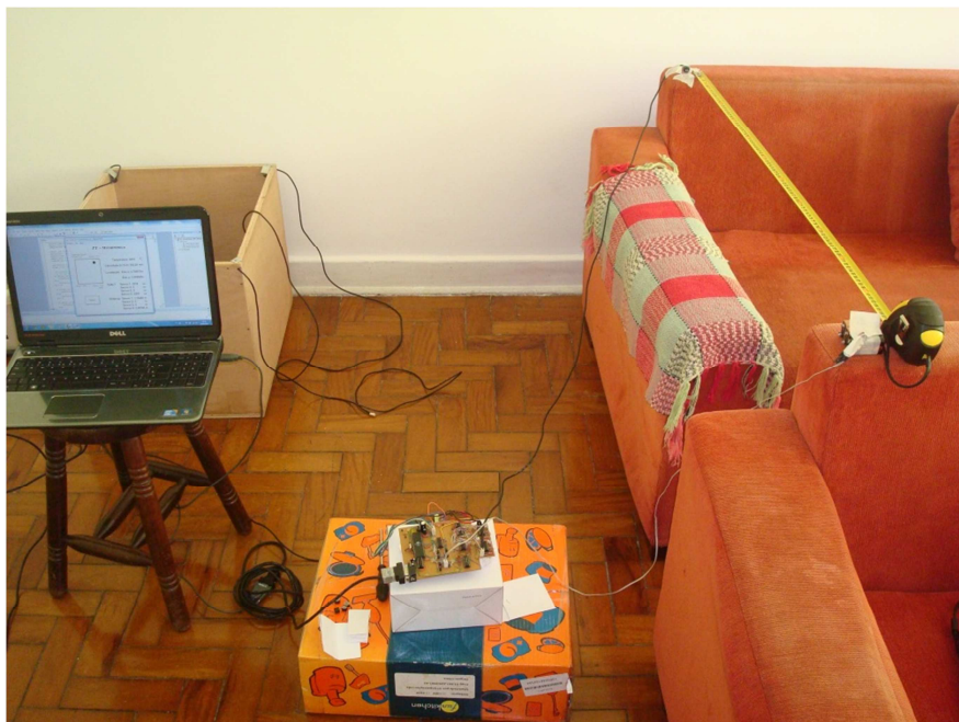
Figura D-2: Testes de medição de distâncias – circuito e interface com usuário.
